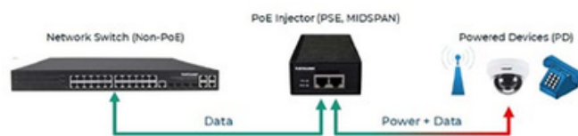
Exemple d'installation avec injecteur PoE :
